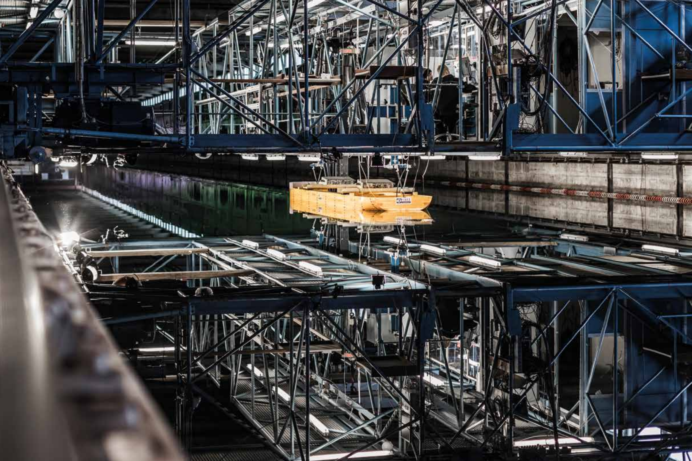
Slæbetanken hos FORCE Technology er 240 m lang og bruges til at finpudse designet på skibe og offshore konstruktioner - Foto/FORCE
